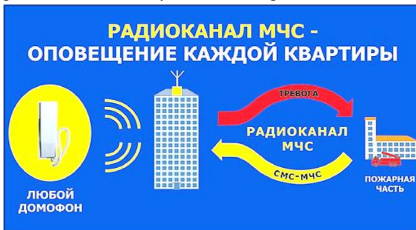
Рис. 2. Оповещение населения о ЧС через домофоны в жилых домах
