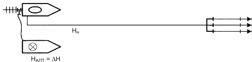
Рис. 16.7. Подача пенообразователя от АПТ во всасывающую полость насоса
