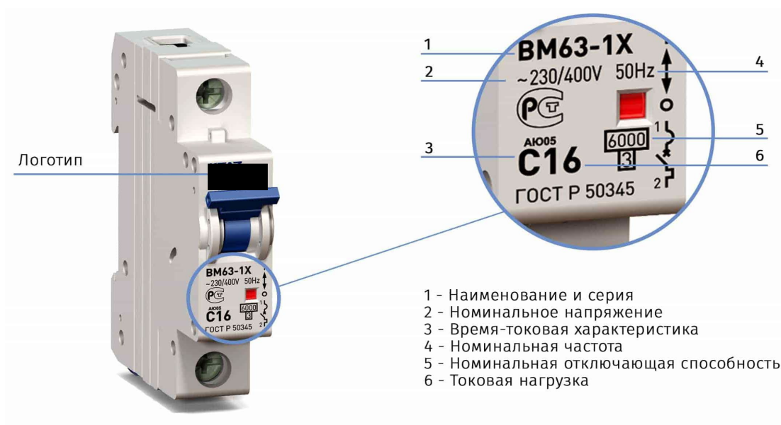
Рисунок 2. Пример маркировки АВ
