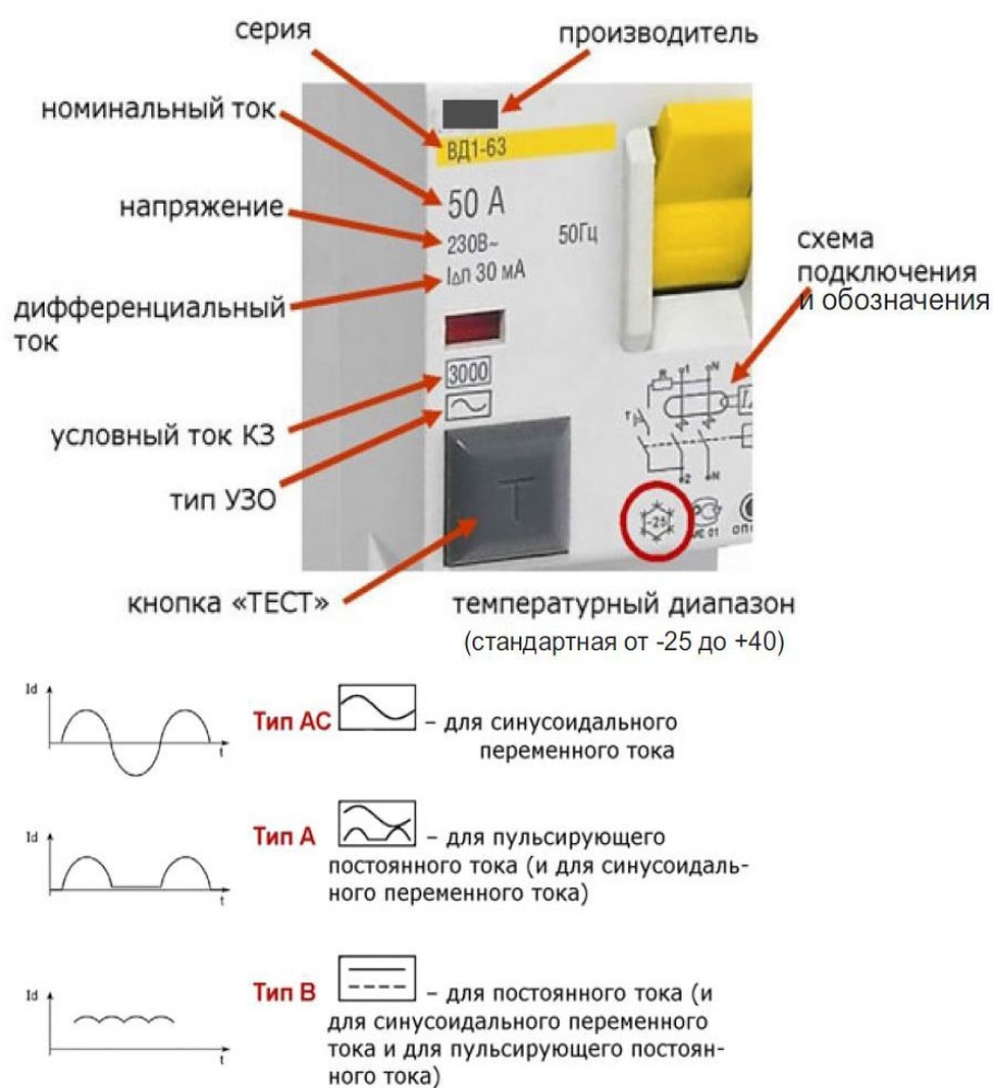
Рисунок 5. Маркировка УДТ
