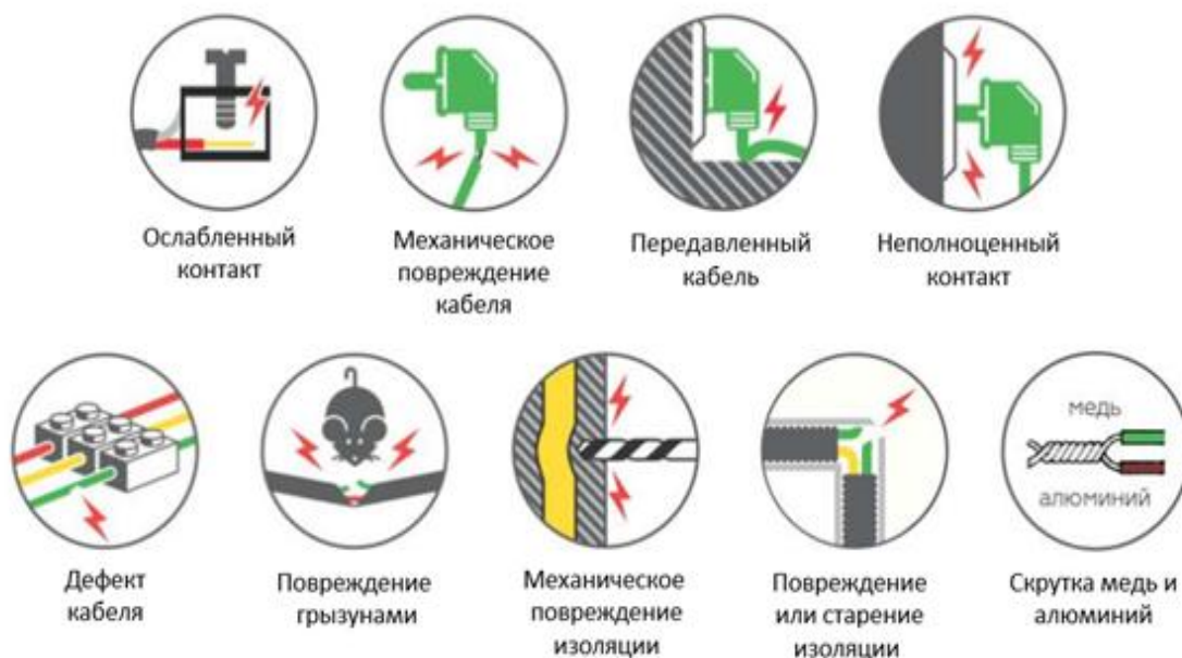
Рисунок 6. Возможные причины искрения в электропроводке
