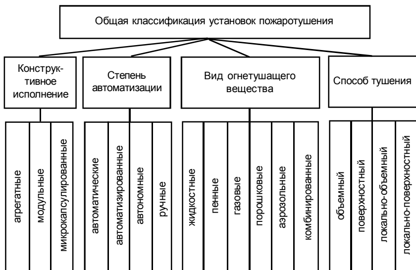
Рис. 11.5. Общая классификация установок пожаротушения
