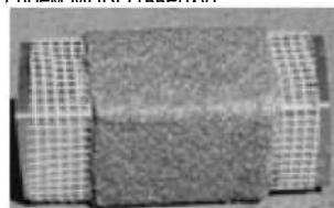
Воздуховод, армированный сеткой, с покрытием ОЗС-МВ
